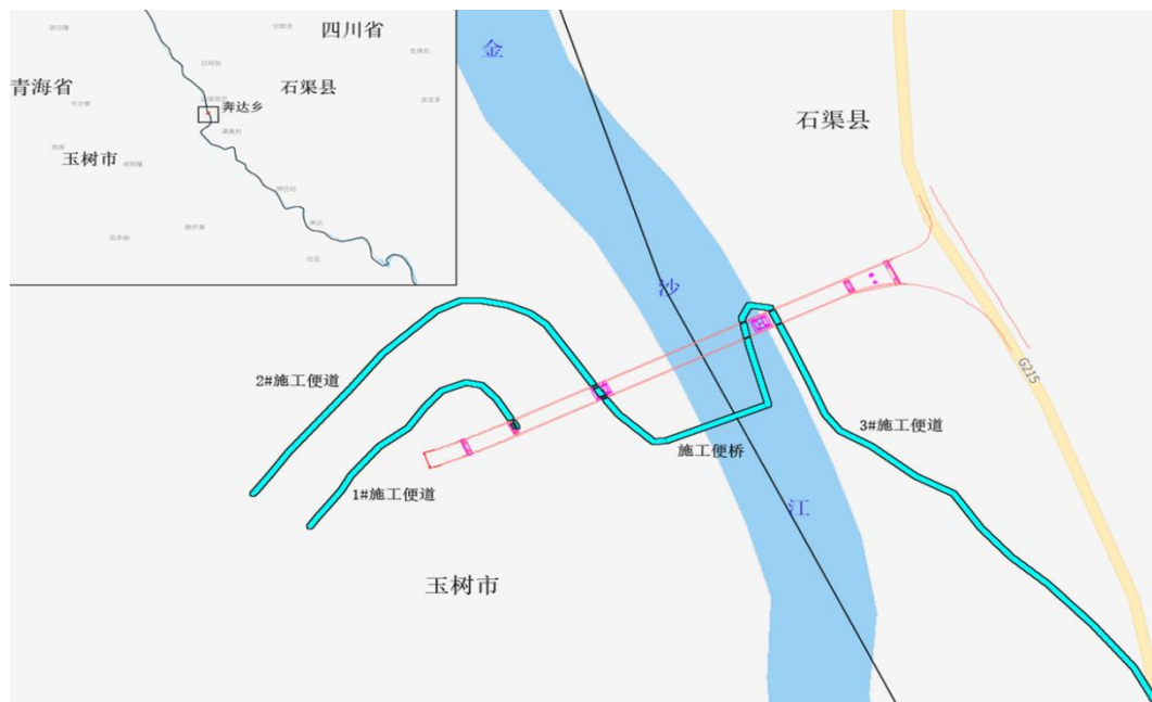
图 1.3-3 本项目施工便道、便桥布置图
